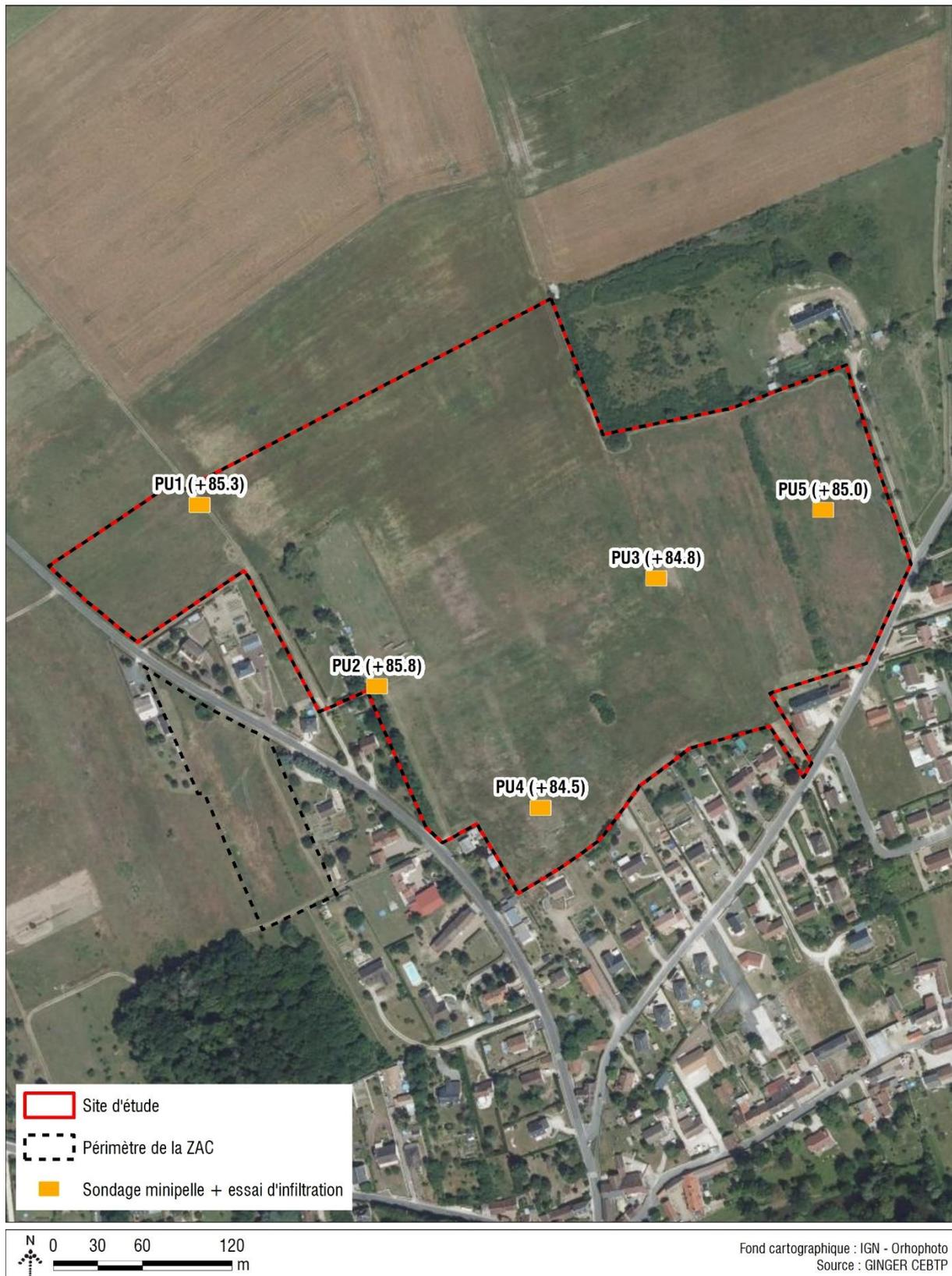
Figure 8 : Localisation des sondages géotechniques
